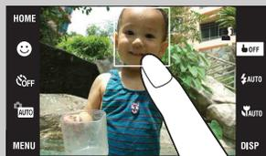
При прикосновении к экрану отображается рамка, а затем при нажатии на кнопку затвора наполовину вниз выполняется фокусировка на объект в рамке.
