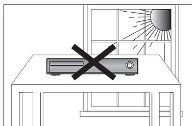
Избегайте воздействия на систему прямого солнечного света и других источников тепла. Это может привести к перегреву системы и нарушению ее нормальной работы.
