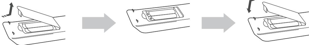
1. Приподнимите крышку отсека батарей в направлении, указанном стрелкой, и снимите ее.
