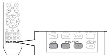
2. С помощью кнопок **MIC VOL** (Громкость микрофона) отрегулируйте чувствительность микрофона.
