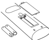
Сняв заднюю крышку, откройте батарейный отсек и вставьте батареи с соблюдением полярности. В пульте могут использоваться батареи 1,5В типа AAA/IEC R03.
