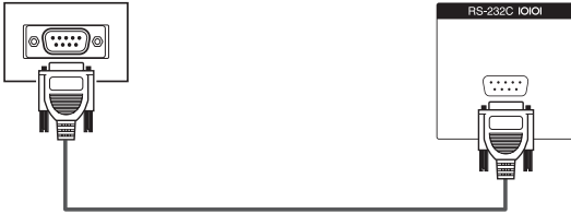
Последовательный управляющий кабель RS-232C (перекрестного типа)
