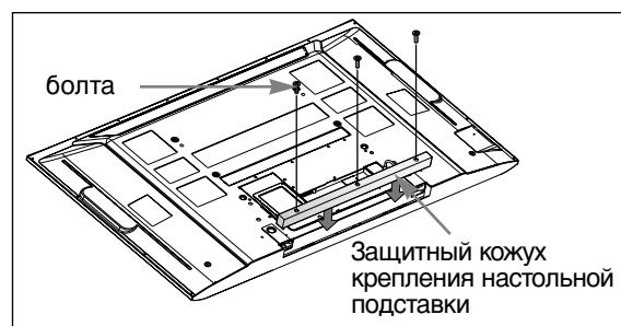
Для предотвращения попадания посторонних материалов в крепление подставки, закрепите защитный кожух крепления настольной подставки винтами, входящими в комплект поставки, как показано на рисунке.
