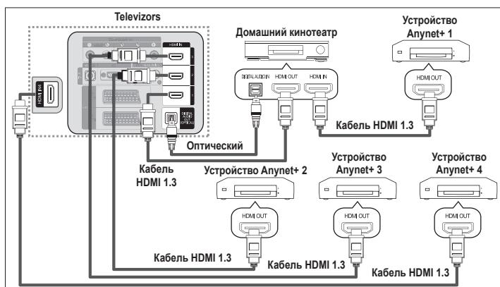
1. С помощью кабеля HDMI соедините гнездо [HDMI 1], [HDMI 2], [HDMI 3] или [HDMI 4] на телевизоре с гнездом HDMI OUT соответствующего устройства Anynet+ .
