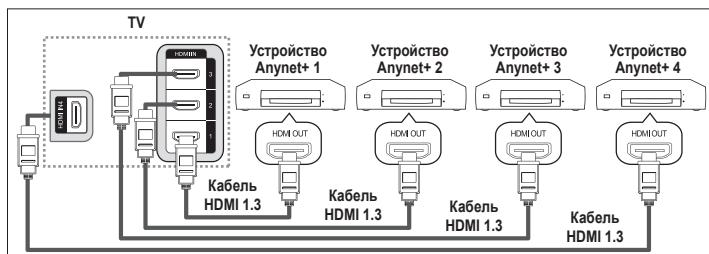
С помощью кабеля HDMI соедините гнездо [HDMI 1], [HDMI 2], [HDMI 3] или [HDMI 4] на телевизоре с гнездом HDMI OUT соответствующего устройства Anynet+.
