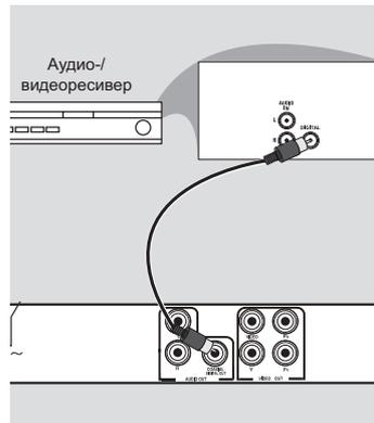
Ресивер, оснащенный декодером форматов PCM, Dolby Digital или MPEG
