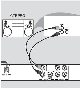
Стереосистема, оснащенная входными аудиогнездами Dolby Pro Logic или Right/Left Audio In
