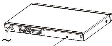
Табличка с техническими данными и предупреждение о технической безопасности имеются на задней панели устройства.
