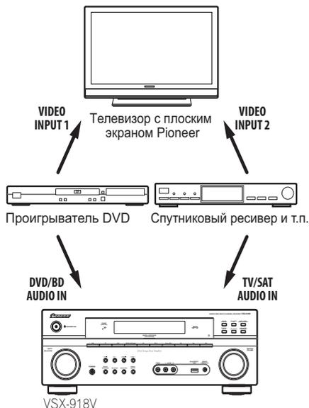
Для оптимального использования функций SR+ следует подключить компоненты-источники сигнала (проигрыватель DVD и т.д.) немного иначе по сравнению с тем, как описано в данном разделе. Подключите видеовыходы каждого компонента непосредственно к телевизору с плоским экраном, а аудиовыходы (аналоговые и/или цифровые) – к ресиверу.
