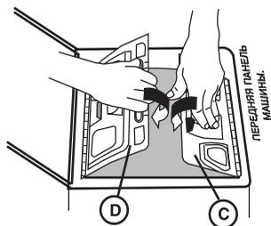
4. Опустить переднюю дверцу **C**. Опустить заднюю дверцу **D**, чтобы крюк передней дверцы **C** надежно вошел бы в щель, затем отпустить дверцы.
