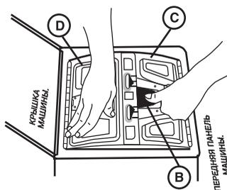
2. Положите руку на заднюю дверцу **D**. Нажать на язычок **B** и, не отпуская его, нажать на переднюю дверцу **C**, чтобы расцепить дверцы **C** и **D**.
