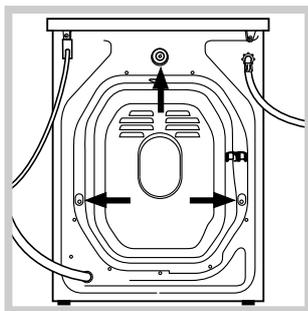
3. Снимите 3 винта, предохраняющие машину в процессе перевозки, и резиновые пробки с соответствующим распорными шайбами, расположенные в задней части стиральной машины (см. рис.).
