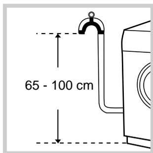
Повесьте загнутый конец сливного шланга на край раковины, ванны, или поместите в специальный вывод канализации. Шланг не должен перегибаться. Верхняя точка сливного шланга должна находиться на высоте 65-100 см от пола. Расположение сливного шланга должно обеспечивать разрыв струи при сливе (конец шланга не должен быть опущен в воду).
