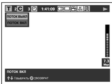
Для выключения отображения индикатора объема потока данных выберите “Поток Выкл.”
