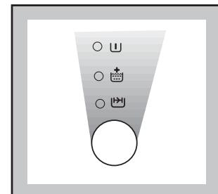
Нажмайте кнопку ДОПОЛНИТЕЛЬНЫХ ФУНКЦИЙ, чтобы загорелась одна лампа.
