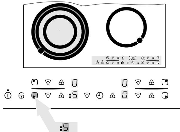
4. Для выключения наружного нагревательного контура прикоснуться к сенсорному полю "Трехконтурная конфорка"
