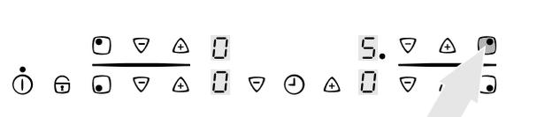
3. Для выключения наружного нагревательного контура прикоснуться к сенсорному полю "Двухконтурная конфорка"
