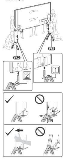
3 Присоединяя напольную подставку к телевизору, фиксируйте ее с помощью винтов <u>M6L23</u> из комплекта поставки, чтобы не допустить падения устройства.
