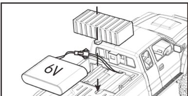
После зарядки снимите крышку в кузове грузовика и установите аккумулятор в батарейный отсек машины.
