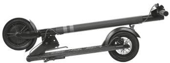
Сложи электросамокат, опустив руль на заднее крыло до щелчка. Крючок должен войти в зацепление с петлёй для складывания
