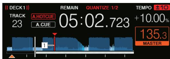
По достижении установленной точки автоматически устанавливается петля и запускается воспроизведение петли.
