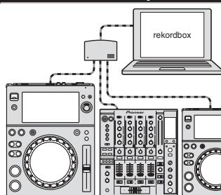
Подключите компьютер и DJ проигрыватель.
