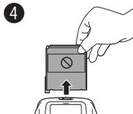
4 Защитный экран фотобумаги (черный) извлекается автоматически, когда крышка отсека для фотобумаги закрывается. Удалите защитный экран фотобумаги из отверстия для вывода отпечатков.
