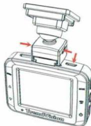
Зарядное устройство подключается к разъему microUSB в кронштейне. Кронштейн имеет два разъема, с левой и с правой стороны. Можно использовать любой. Питание с кронштейна на видеорегистратор передается с помощью группы контактов. Также зарядное устройство можно подключить напрямую в регистратор. Кабель зарядного устройства имеет длину 3 метра, возможна скрытая проводка.
