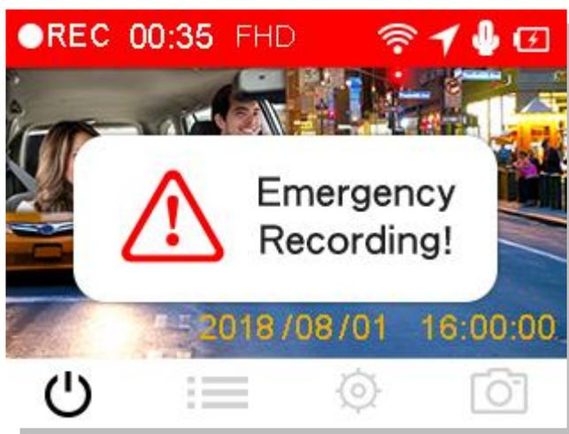
**Создание экстренных записей по сигналу G-сенсора:** если во время видеозаписи будет зафиксировано столкновение, DrivePro автоматически включит режим экстренной записи.
