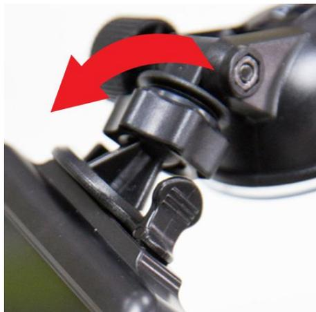
5. Когда DrivePro будет расположен наилучшим образом, заверните барашек фиксатора против часовой стрелки, чтобы надежно закрепить устройство в выбранном положении.
