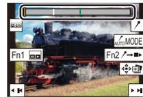
\*1 Фотокамера автоматически устанавливает метки на сценах с распознанным лицом или движением объекта.
