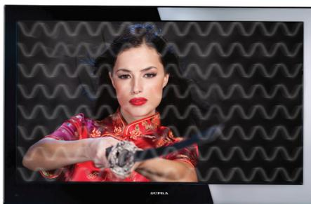
**Изображение с кривыми линиями и дрожит.** Обычно это вызвано электромагнитным излучением работающих вблизи приборов (фенов, мобильных телефонов, радиоприемников или радиопередатчиков).
