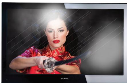
Диагональные полосы и «елочки» на изображении, часть изображения отсутствует. Обычно это вызвано использованием рядом с телевизором электро-термического оборудования (в больнице).
