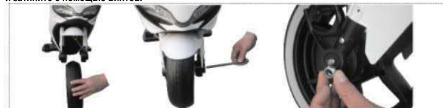
Установка переднего колеса: переднее колесо, поместите в середину корпуса вилки, сопоставьте отверстия с обеих сторон, чтобы колесо проходило, а затем затяните гайки с обеих сторон.
