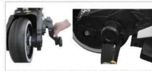
Установка вспомогательных колес: вставляются с обеих сторон заднего колеса, как показано выше. Вставьте и закрепите четырьмя винтами.
