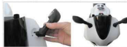
Установка зеркала: Разместите с обеих сторон спереди, вставив в корпус.
