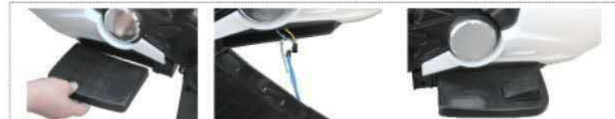
Установка педалей: пазы для педалей расположены с обеих сторон корпуса. Вставьте педаль с одной стороны, затем с другой стороны и соедините с проводкой и крепко прижмите.
