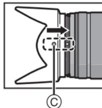
**2 Drehen Sie die Gegenlichtblende in Pfeilrichtung, bis sie stoppt, und richten Sie die Stop-Markierung **(D)** an der langen Seite der Gegenlichtblende mit der Markierung am Rand des Objektivs aus.**
