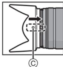
2 朝箭頭指示的方向轉動鏡頭遮光罩直到停止為止，將鏡頭遮光罩的長的部分上的停止標記 **Ⓓ** 對準鏡頭頂端的標記。
