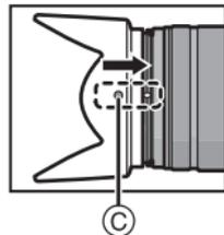
**2** Поверните бленду объектива до полной остановки в направлении, указанном стрелкой. При этом метка остановки на длинной стороне бленды объектива **Ⓓ** должна совпадать с меткой с края объектива.
