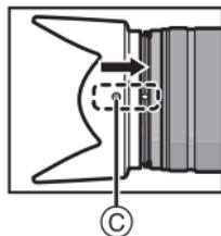
2 Gire la visera de la lente en la dirección de la flecha hasta que se detenga y alinee la marca de tope (D) en el lado largo de la visera de la lente con la marca en la punta de la lente.
