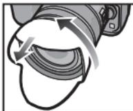
2 Drehen Sie die Gegenlichtblende um und setzen Sie sie wie oben beschrieben wieder auf.
