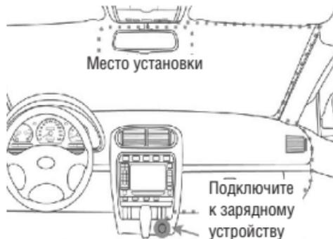
2. Пожалуйста, не устанавливайте устройство в таком положении, которое отвлекает внимание водителя и загоразживает линию обзора.
