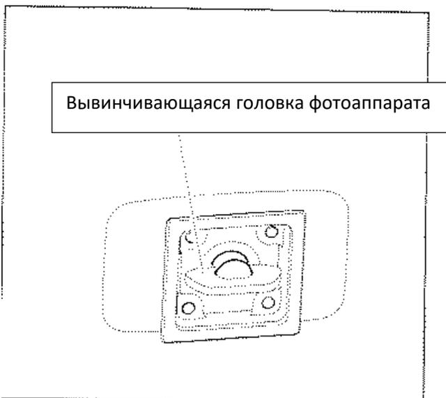
Прикрепите винт фотоаппарата к его нижней части и закрутите при помощи вывинчивающейся головки фотоаппарата, расположенной на обратной стороне пластины быстрого крепления.
