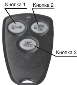
Миниатюрный радиопередатчик, питающийся от 3 вольтовой батарейки (CR2032), которой хватает примерно на 1 год эксплуатации. Существенное снижение дальности приема системой команд передатчика говорит о необходимости замены батарейки. На пульте расположены три кнопки управления и индикаторный светодиод. Алгоритм формирования и передачи управляющих команд идентичен двунаправленному пульту управления. Однонаправленный пульт предназначен только для управления сигнализацией.
