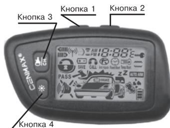
В случае приема встроенным в пульт пейджером сигнала тревоги, Вы услышите звуковой сигнал и на ЖК-дисплее отобразится соответствующая пиктограмма.
