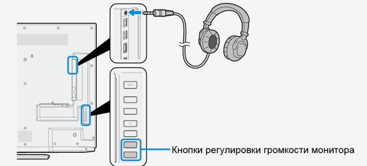
Терминал для наушников (разъем «мини-джек» стерео \phi 3,5)
