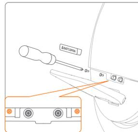
Выключите питание моноколеса. Откройте резиновую мягкую заглушку на левой стороне корпуса устройства (как показано на рисунке, выше подножки) и открутите оба винта при помощи крестовой отвертки.
