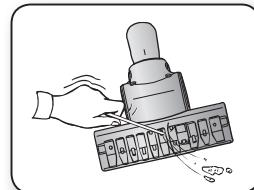
Установите кнопку блокировки в положение UNLOCK и удалите засор.
