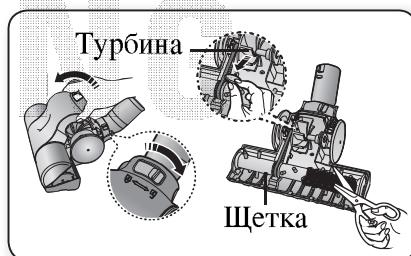
Чтобы собрать насадку, совместите крышку с передней частью корпуса и установите ее на место. Закрыв крышку, установите кнопку блокировки в положение LOCK.
