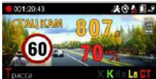
В том случае, если скорость автомобиля превышает установленный на этом участке дороги предел, прибор сообщает об этом звуковым сигналом и окрашивает значение скорости автомобиля, указанную на дисплее в красный цвет. При определении комплексов: “Переезд”, “СТР-ВБ” и “Дор-Фин” звукового оповещения не будет, т.к. они не определяют скорость автомобиля.
