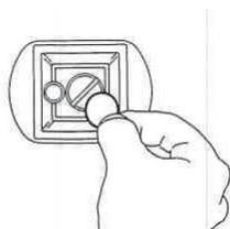
Вставьте крепежную опору штативное гнездо вашей камеры до упора. Крепко закрутите винт по часовой стрелке «монеткой», как показано на рисунке выше. Пружинобразный штырь для видеокамеры должен крепиться во второе отверстие в основании видеокамеры, так как штырь видеокамеры – втягивающийся, это позволяет без каких-либо проблем закрепить камеру только в одно отверстие.
