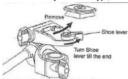
Рис. 1. Как закрепить камеру (только для EX-330Q/344Q/Macro)
