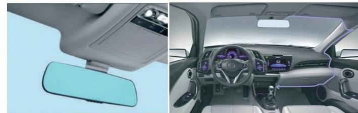
**Примечание.** Вы можете сделать скрытую проводку, пропустив провод зарядного устройства вдоль кромки ветрового стекла, как показано на рисунке выше.
