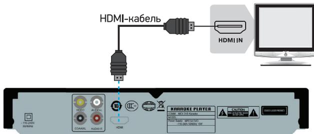
Соедините HDMI-разъем цифрового устройства отображения с HDMI-разъемом DVD-плеера (не входит в комплект поставки).
