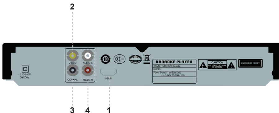
1. Интерфейс HDMI для передачи сигнала высокой четкости
