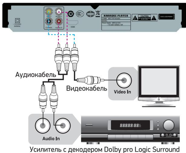
1. Соедините композитный видеовыход DVD-плеера с композитным видеовходом телевизора при помощи аудиовидеокабеля, входящего в комплект поставки.
