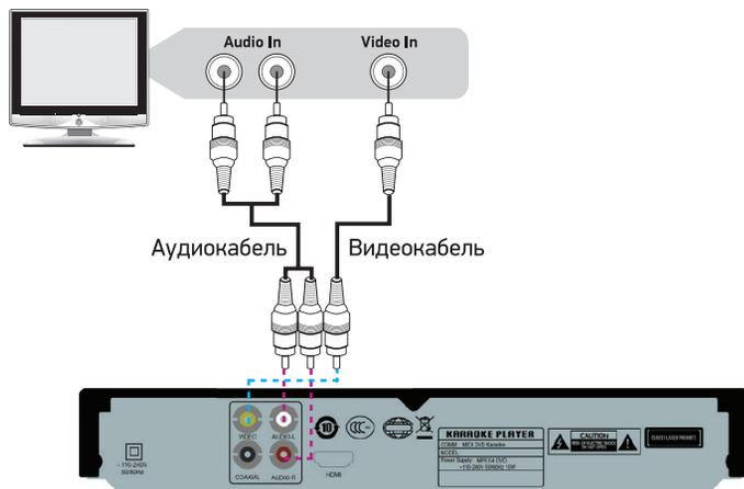
1. Соедините композитный видеовыход DVD-плеера с композитным видеовходом телевизора при помощи аудиовидеокабеля, входящего в комплект поставки.
