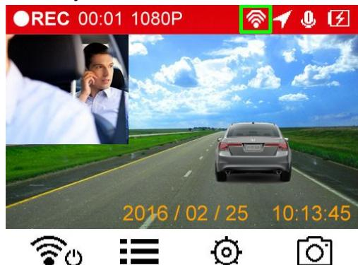
2. Значок на экране означает, что вы можете подсоединиться к DrivePro™ с помощью своего мобильного устройства.
