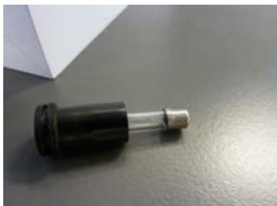
Замените предохранитель на аналогичный (T1. 6AL/250V) и установите его в АС. Проверьте работу АС, включив ее и проверив, что светодиоды загорелись.
