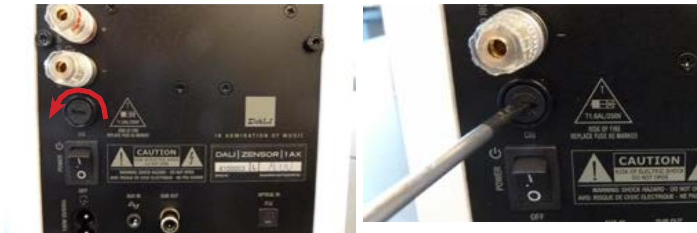
Удалите предохранитель, повернув крышку против часовой стрелки (см. изображение) при помощи отвертки с плоским шлицем.
