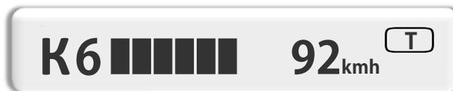
Звуковое оповещение о радаре выдаётся прерывистым сигналом, частота повторения которого увеличивается по мере роста уровня сигнала. Чем ближе радар, тем больше уровень его сигнала.
