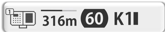
На рисунке: Движение на участке с разрешённой скоростью 60 км в час, расстояние до радара **Стрелка** 365 метров, движение со скоростью 80 км в час, режим приёма **ГОРОД2**, сигналов радаров нет.
