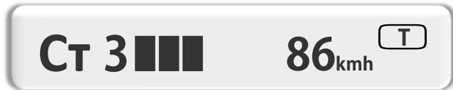
При обнаружении сигнала радара Стрелка во время оповещения по базе данных, в правой части дисплея выводится сокращённое обозначение радарного комплекса и уровень его сигнала в цифровом и графическом виде. На рисунке: Движение на участке с разрешённой скоростью 60 км в час, расстояние до радара **Стрелка** 316 метров, обнаружен сигнал радара с уровнем 4.
