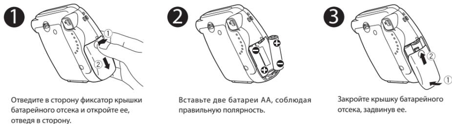
Отведите в сторону фиксатор крышки батарейного отсека и откройте ее, отведя в сторону.
