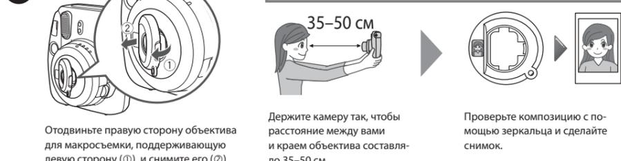
Отодвиньте правую сторону объектива для макросъемки, поддерживающую левую сторону (1), и снимите его (2).
