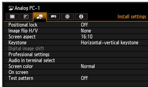
**3** Выберите параметр [Screen aspect/Соотношение сторон экрана] с помощью кнопок [▲] / [▼] и нажмите кнопку OK.
