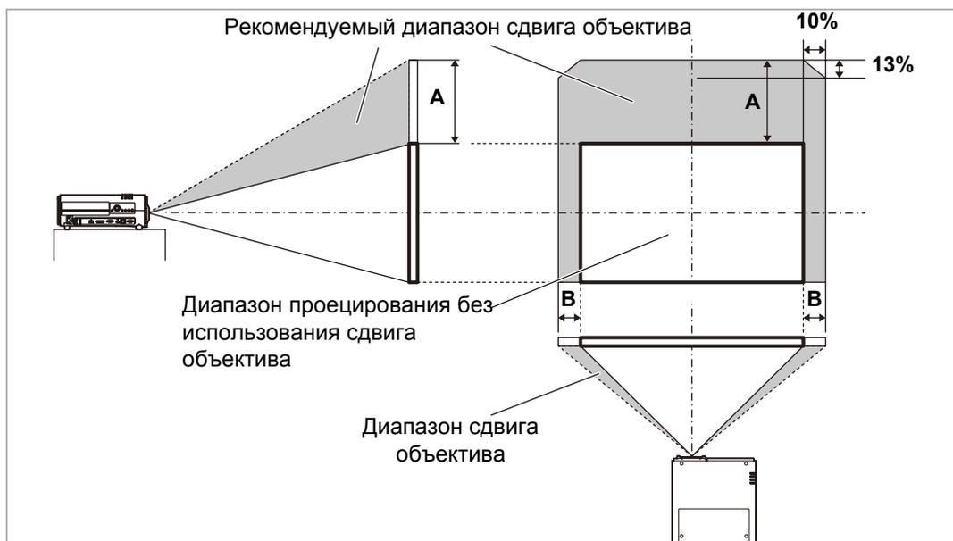
Максимальное перемещение вверх (A) и горизонтальное перемещение (B) с помощью сдвига объектива (справочные значения, в см)
