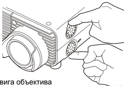
Регулятор горизонтального сдвига объектива
