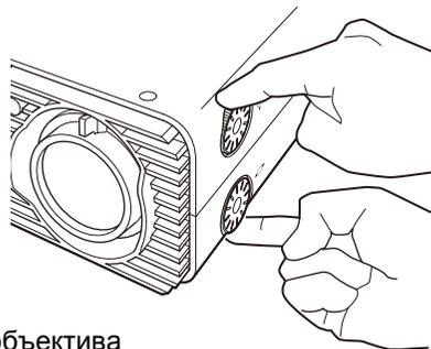
Регулятор горизонтального сдвига объектива
