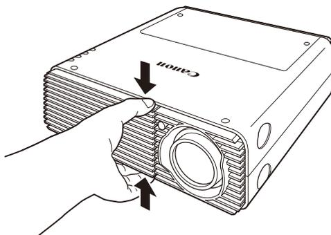
**3** Откройте крышку фильтра и снимите ее.
