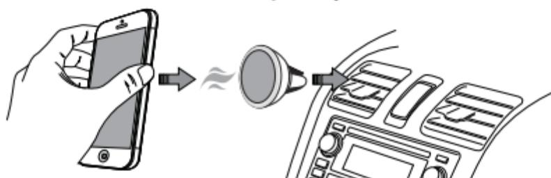
**3 -** Приложите мобильное устройство закрепленной металлической пластиной к держателю. Устройство будет надежно закреплено.
