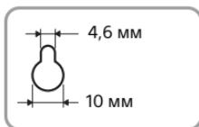
Отверстие на задней панели основного устройства
