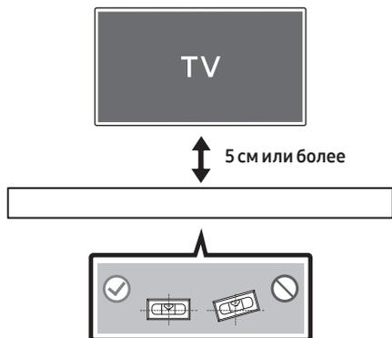
2. Совместите **центровую линию** бумажного шаблона с центром вашего ТВ (при монтаже устройства Soundbar под ТВ), а затем зафиксируйте **направляющая настенного крепления** к стене с помощью ленты.
