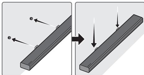
8. Передвиньте устройство Soundbar вниз, как показано ниже, так чтобы **кронштейны крепления к стене** плотно сели на **держатели**.
