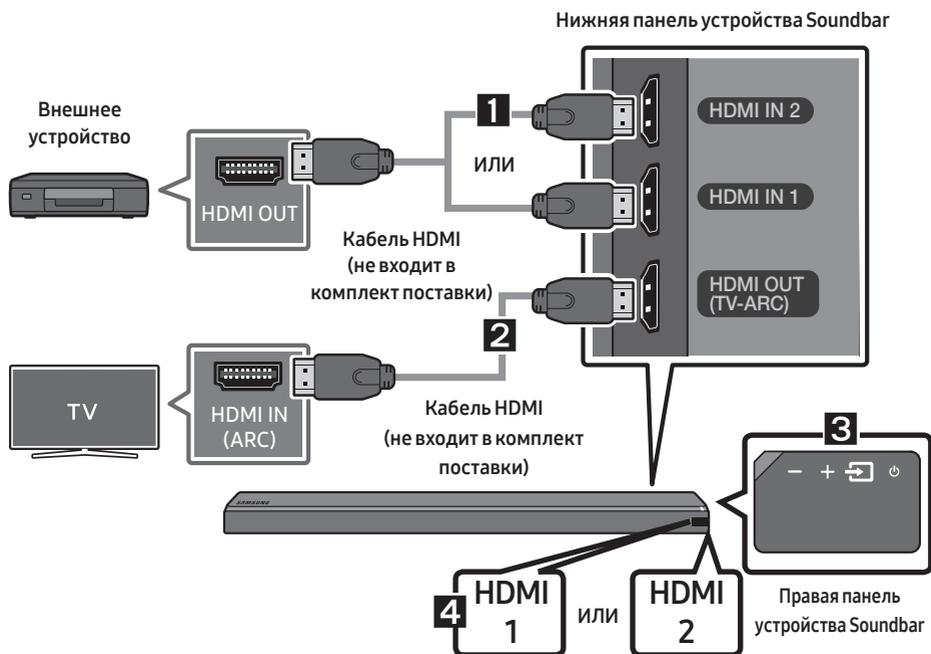
1. Подключите кабель HDMI (не входит в комплект поставки) с разъема **HDMI IN 1** или **HDMI IN 2** на задней панели устройства к разъему **HDMI OUT** на вашем цифровом устройстве.
