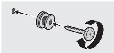
6. Установите 2 **кронштейны крепления к стене** в правильном направлении на нижнюю панель устройства Soundbar, используя 2 **винта**.
