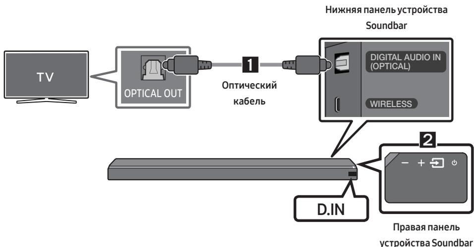
1. Подключите разъем **DIGITAL AUDIO IN (OPTICAL)** на устройстве Soundbar к разъему OPTICAL OUT на ТВ при помощи цифрового оптического кабеля.
