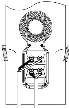
Upewnij się, że gniazda połączeniowe oznaczone +, z czerwonym obramowaniem zostały połączone z gniazdem o dodatniej polaryzacji na wzmacniaczu a gniazda oznaczone - , z czarnym obramowaniem z gniazdami o ujemnej polaryzacji na wzmacniaczu. Nieprawidłowe połączenie będzie skutkowało pogorszeniem jakości dźwięku i utratą niskich tonów.
