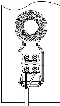
Все подключения делаются только при выключенном оборудовании.
