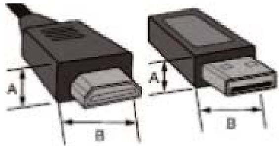
Размер входного разъема HDMI кабеля не должен превышать 10 мм (A) x 20 мм (B).
