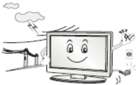
Для дополнительной защиты данного телевизора при грозовой погоде или когда не планируется его использование в течение длительного времени, отключите телевизор от розетки питания и отсоедините антенный кабель. Это предотвратит повреждение телевизора от молнии или из-за перепадов напряжения.
