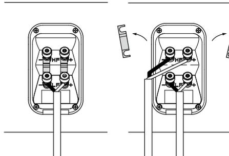
Подсоедините плюсовой разъем колонки (со знаком + и окрашенный в красный) к плюсовому выходу усилителя, а минусовой (со знаком - и окрашенный в черный) – к минусовому на усилителе. Неверное подключение приведет к искажению звукового образа и утере басов.
