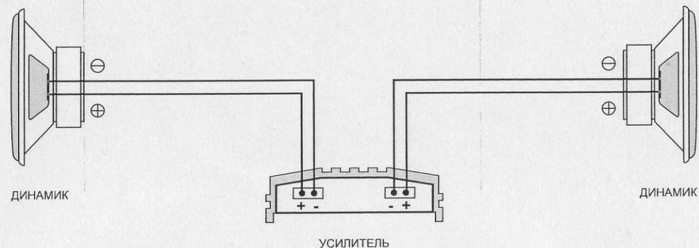
Б) Схема подключения компонентных динамиков.
