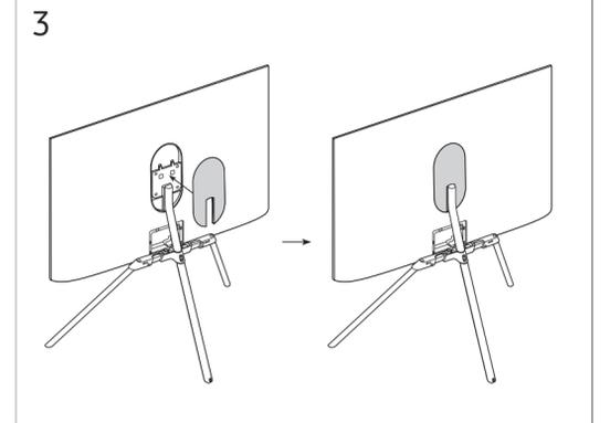
5-B Q7C 55"/65", Q8C 65", Винты: M4 x L16
